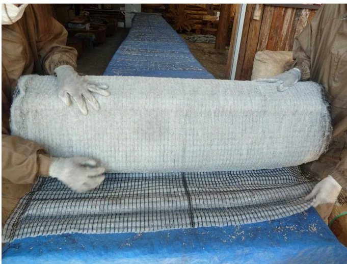
植生基材封入袋を種子付き二重ネットに等間隔に装着
