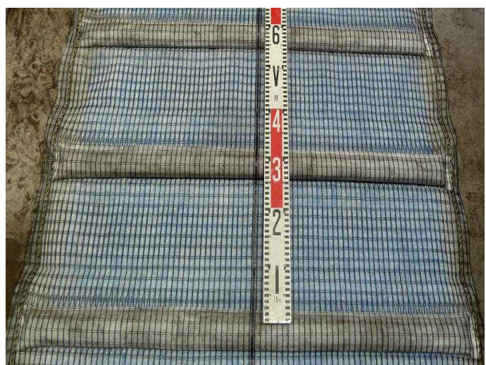
植生基材封入袋を種子付き二重ネットに等間隔に装着
