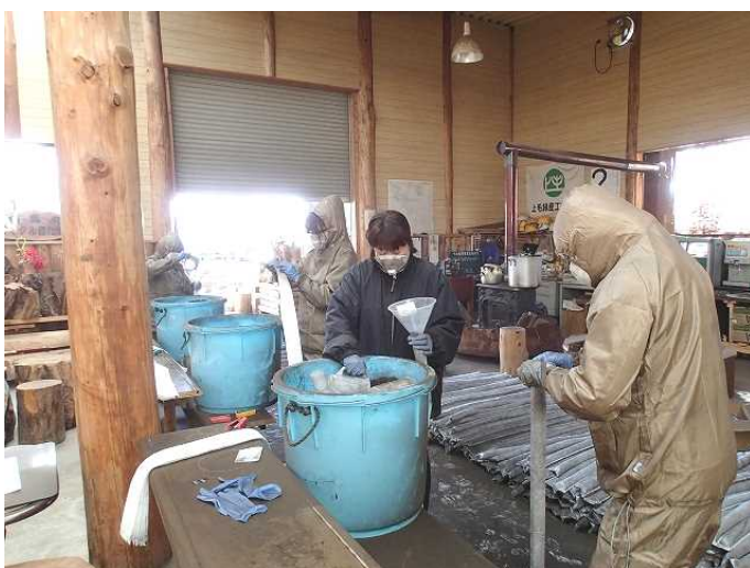
植生基材を円筒の袋に封入（植生基材封入袋）
